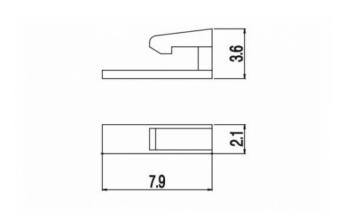
La qtà ordinata si riferisce ai singoli polarizzatori POL-P. I polarizzatori sono realizzati e forniti in raggruppamenti da 6 pz per praticità di manipolazione.
